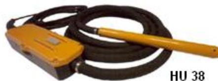
Los Vibradores internos de alta frecuencia HU con el convertidor integrado , se conectan directamente a la red eléctrica a 230 V, 50/60 Hz, consisten en una unidad tractora llamada cabeza de vibración, cable eléctrico de 10 metros y tubo de control de 5 metros internamente reforzado.
