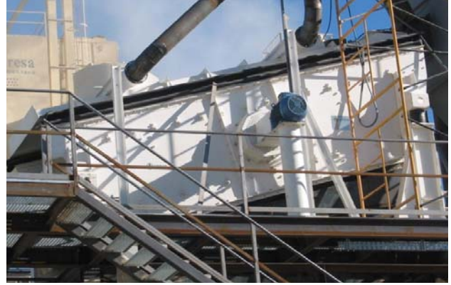
Cribas accionadas por vibrador mecánico, con movimiento multidireccional o circular.
