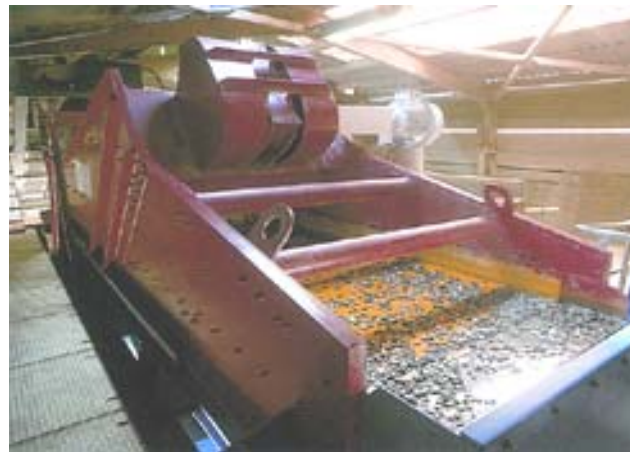
Cribas accionadas por vibrador mecánico, con movimiento unidireccional o lineal.
