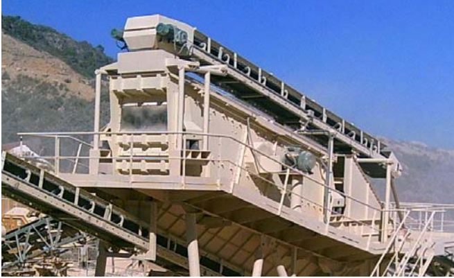
Cribas accionadas por vibrador mecánico, con movimiento multidireccional o circular.
