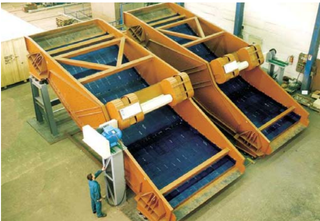
Cribas accionadas por vibrador mecánico, con movimiento unidireccional o lineal.
