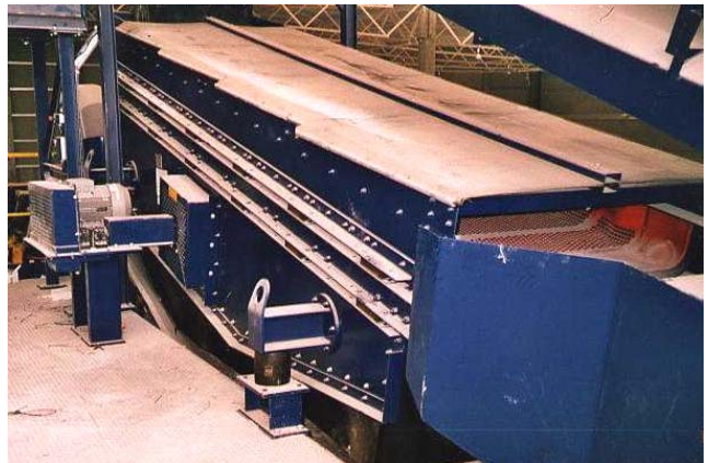
Cribas de malla anticolmatante.
