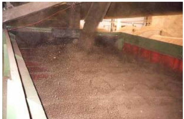
Cribas accionadas por vibrador mecánico, con movimiento unidireccional o lineal.
