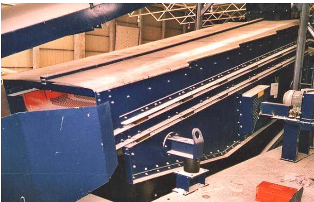
Cribas de malla elástica BIVITEC, para productos colmatantes.
