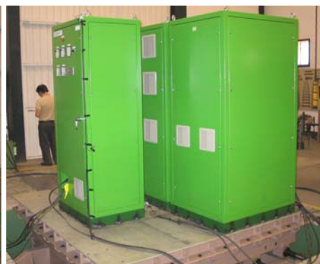
Rectificador fabricado por JEMA para la Planta de Regasificación de Sagunto.
