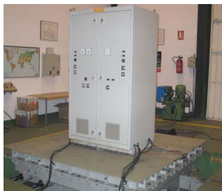
Armario de Excitación de ALSTOM para la Central de Lungmen (China).
