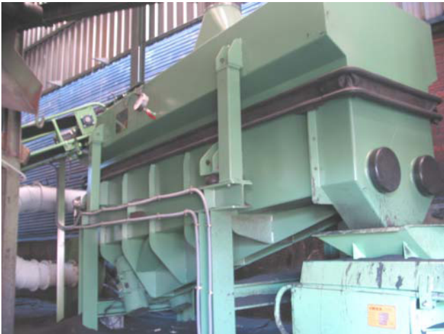
Accionado mediante 2 vibradores eléctricos externos.
